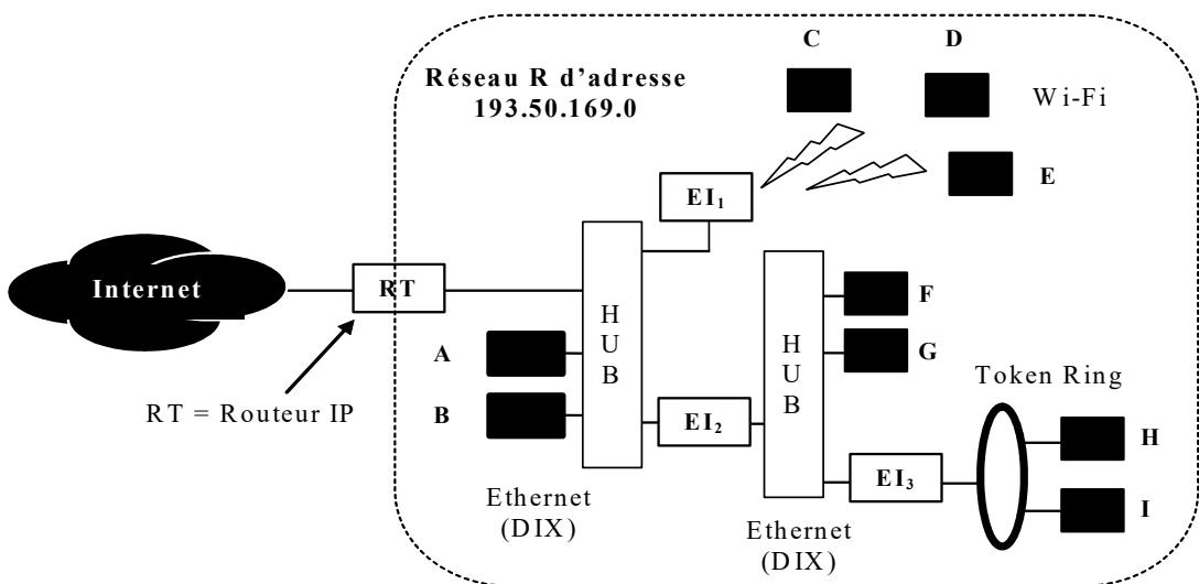
1. On souhaite configurer R en 3 sous-réseaux IP ( $SR_1$ ,  $SR_2$  et  $SR_3$ ). On souhaite également que les deux HUB Ethernet ne soient pas sur le même domaine de collision.
