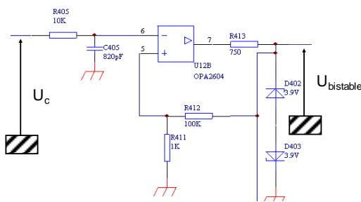
Les seuils du bistable sont à présent symétriques mais la valeur de la tension de saturation de l'A.O n'est plus  $\pm U_{SAT}$  mais  $\pm(V_z + 0.6V)$  ce qui a pour conséquence la modification :
