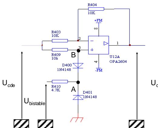
Le comportement de ce système est réglé par la conduction ou le blocage de diodes  $D_1$ ,  $D_2$  contrôlées par le signal de sortie du bistable dont le potentiel électrostatique  $U_{\text{bistable}}$  ne peut prendre que deux valeurs  $\pm U_{\text{SAT}}$  tensions de saturation de l'A.O.
