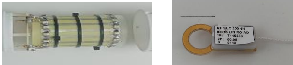
Figure 1 : Cage d'oiseau (à gauche) et spire à positionner sur la zone à cartographier
