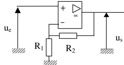
A supposer que l'on souhaite fixer le facteur d'amplification en tension du montage à la valeur 10 (soit 20dB), on ne dispose que d'une équation  $R_2=9R_1$  pour fixer les valeurs de résistances des résistors  $R_1$  et  $R_2$ .
