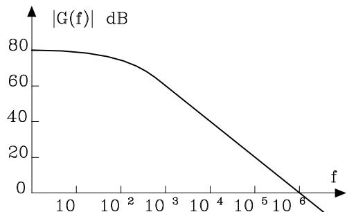
☒ Déduire du tracé du gain en boucle ouverte dans le plan de BODE le gain statique  $A_0$  et  $f_c$  fréquence de coupure à -3dB. Justifier la précision avec laquelle on détermine la bande passante.
