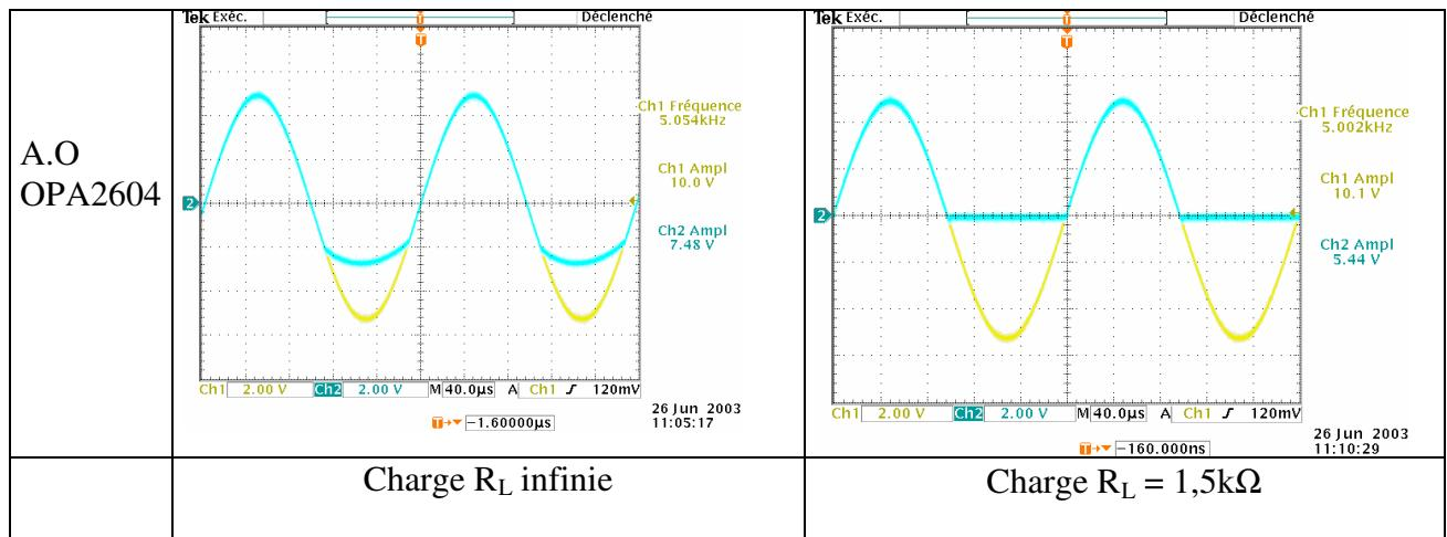
Remarque : la connexion d'une impédance de charge assure la polarisation en courant de la diode. On observe également une déformation du signal de sortie  $u_s$  dans le cas d'utilisation du LM741. Cette distorsion est fonction du type d'A.O utilisé et de la fréquence du signal d'entrée, vue qu'elle apparaîtra aussi dans le cas d'un montage sur la base de l'OPA2604 pour de plus hautes fréquences du signal d'entrée.
