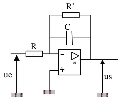
Cette équation différentielle est semblable à celle régissant le fonctionnement du montage pseudo-intégrateur. On peut donc transcrire les conditions d'intégration dans le cas d'un signal d'entrée  $u_e$  sinusoïdal de période  $\tau$  :
