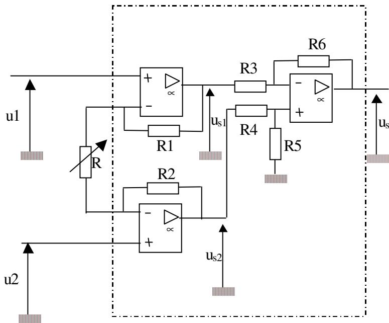
On identifie l'expression de  $u_{s1}$ ,  $u_{s1} = \left(1 + \frac{R_1}{R}\right)u_1 - \left(\frac{R_1}{R}\right)u_2$  par application du théorème de superposition avec les sources de tension  $u_1$  et  $u_2$  considérées parfaites :
