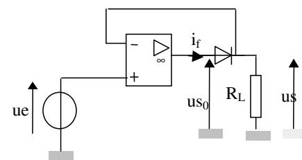
La diode semble être un bon candidat pour réaliser cette fonction, en dépit de sa tension de seuil  $V_D$ . Ce défaut peut être corrigé par le montage à base d'A.O
