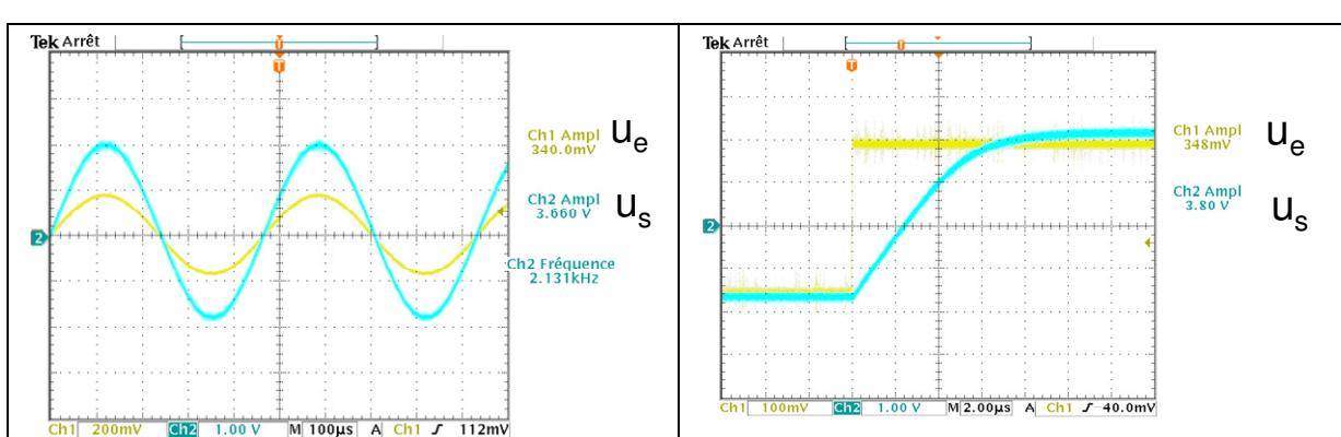
En augmentant l'amplitude du signal d'entrée, on observe sur le phénomène de saturation en amplitude inhérent aux tensions d'alimentation de l'A.O. Il est opportun de valider le fait que la saturation est obtenue pour un niveau de signal d'entrée légèrement inférieur au niveau de tension de saturation théorique :
