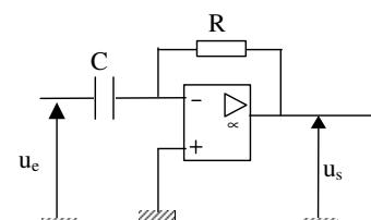
Posons  $R=10k\Omega$ ,  $C=100nF$  et observons la réponse du montage déivateur à un signal d'entrée de forme triangulaire.
