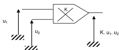
Multiplier est une des fonctions à la base de la modulation des signaux, étant donnée la propriété de translation spectrale qui en résulte. Bien que l'association d'un montage logarithmique à un montage exponentiel puisse réaliser la combinaison  $u_1 u_2 = \exp[\log u_1 + \log u_2]$ , il existe des composants dits multiplicateurs étant à titre d'exemple l'AD835.
