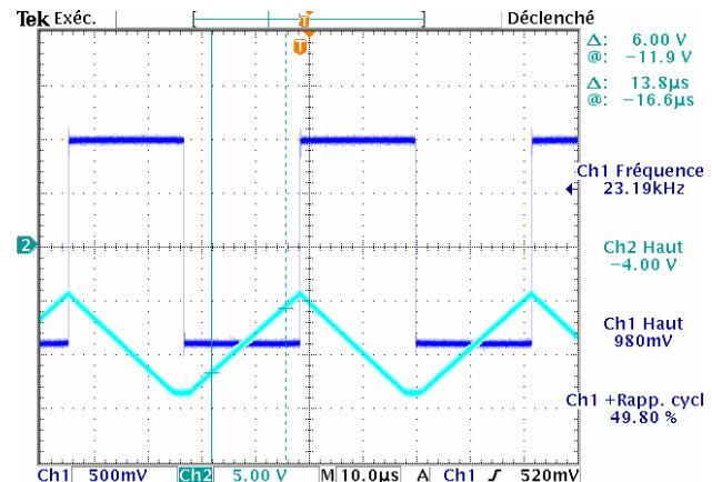
En positionnant une résistance  $R'$  égale à  $2\text{M}\Omega$  en parallèle avec le condensateur, on supprime une partie de la composante continue, et on retrouve une forme d'onde quasi « symétrique »
