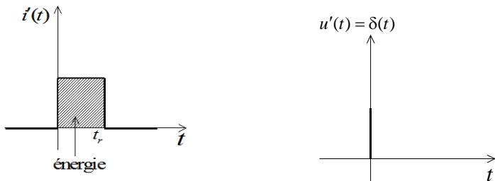
la fonction  $\delta(t)$  est associé à l'impulsion de Dirac et représente une impulsion de très courte durée, de grande amplitude transportant une énergie finie.
