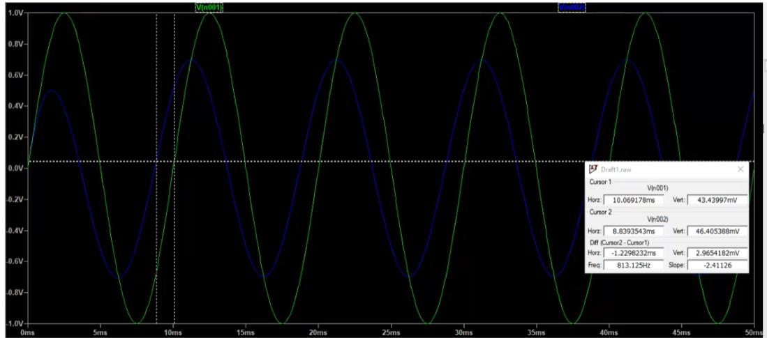
Calcul du déphasage entre la tension d'entrée et la sortie :
