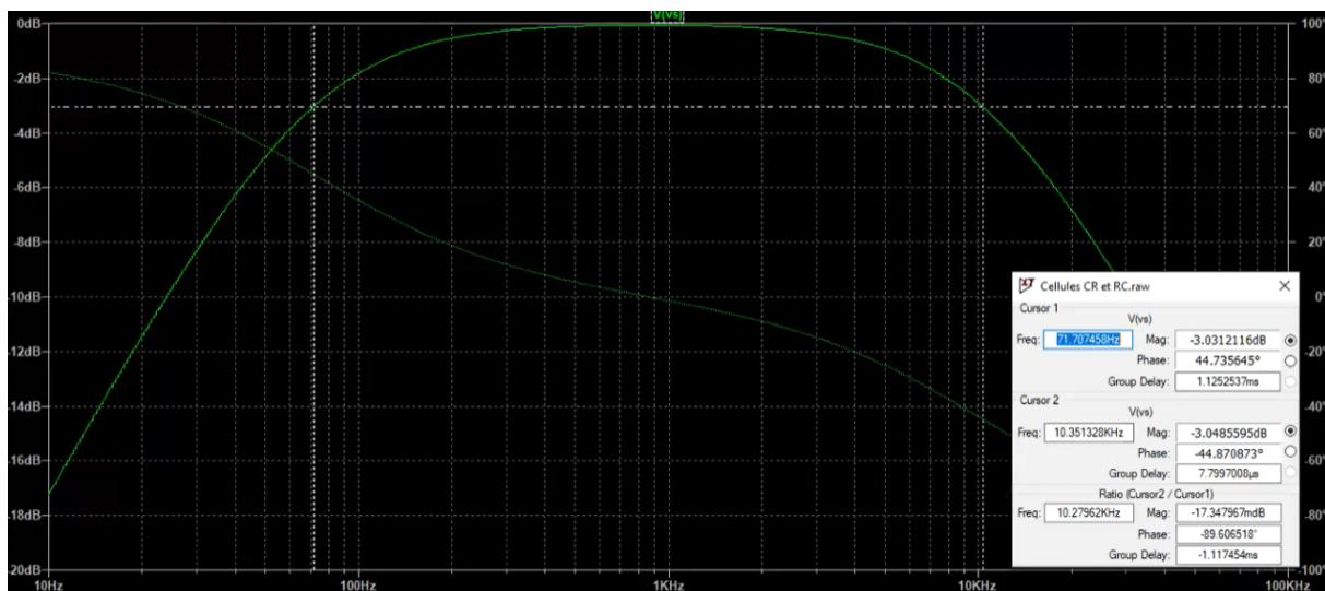
Fréquence de coupure :  $f_{C1} = 71.7\text{Hz}$  et  $f_{C2} = 10.3\text{kHz}$
