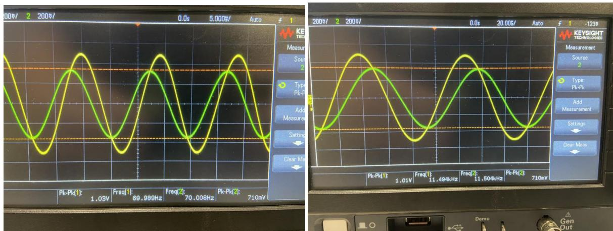
On cherche les deux fréquences pour lesquelles on obtient les tensions de sortie de 710mV.
