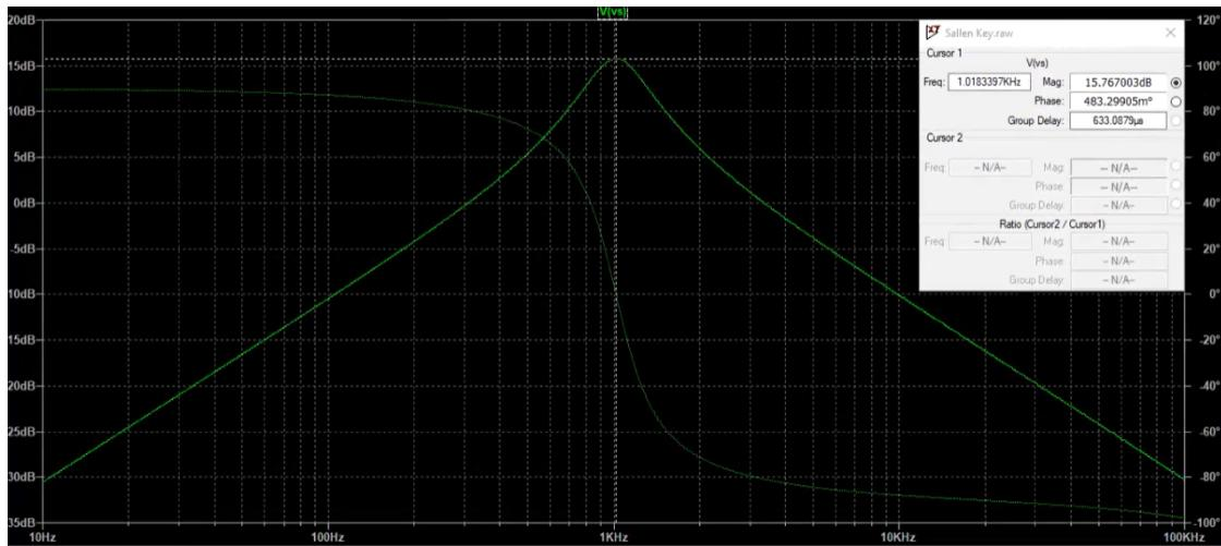
Ce diagramme est un passe bande avec un Gain max de 15.8 dB pour une phase de 0°.
