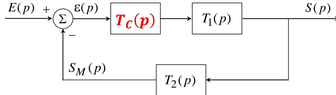
$$T_1(p) = \frac{1}{(1 + 0,1p)(1 + 0,2p)(1 + 0,3p)} \quad T_2(p) = 1$$
