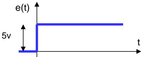
En théorie, un « échelon » est un signal qui prend une valeur à  $t=0$  et la garde indéfiniment. En pratique, pour observer la réponse à un échelon avec un oscilloscope, on utilisera un signal carré périodique. Pour être assimilable à un échelon, ce signal devra rester suffisamment longtemps au même niveau pour que le signal de sortie soit stabilisé : faire durer le niveau indéfiniment ne changerait alors rien.
