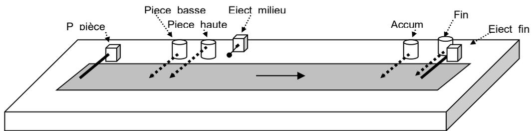
Le tapis roulant permet d'effectuer le tri entre des pièces hautes et des pièces basses. Le tapis est mû par un moteur qui dispose de 2 vitesses (grande ou petite).
