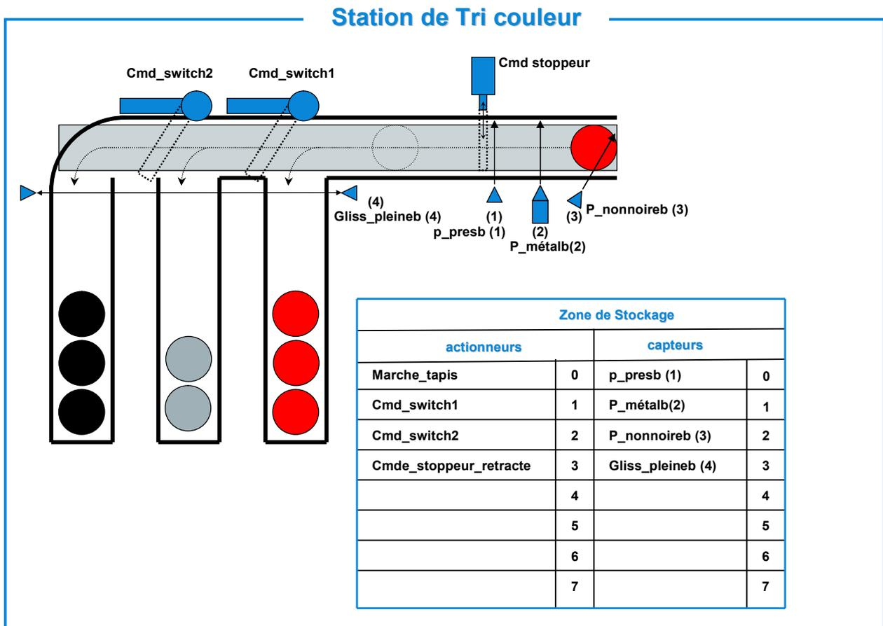
Les capteurs sont connectés sur le port P2. (Tous les capteurs sont actifs à 0)
